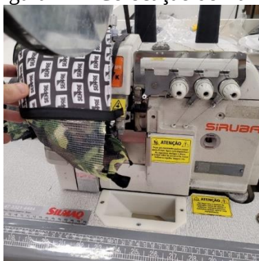
Figura 12 – Colocação do fitilho
