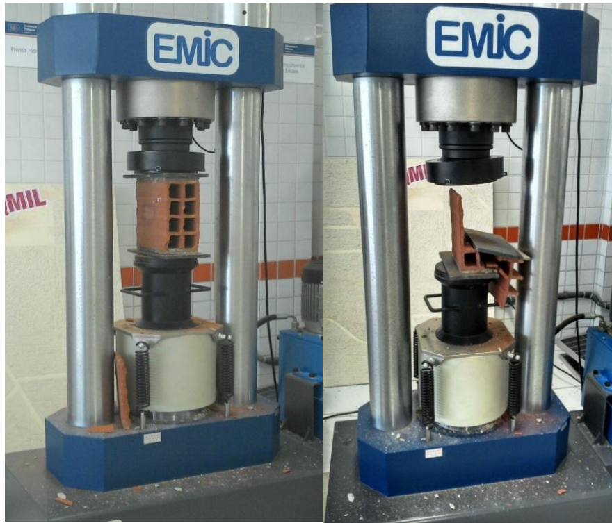
Figura 23 – (a) Carga sendo aplicada no bloco cerâmico. (b) Rompimento do bloco após limite de carga aplicada
