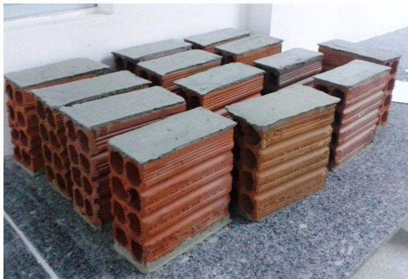
Figura 22 – Capeamento dos blocos da Cerâmica C.
