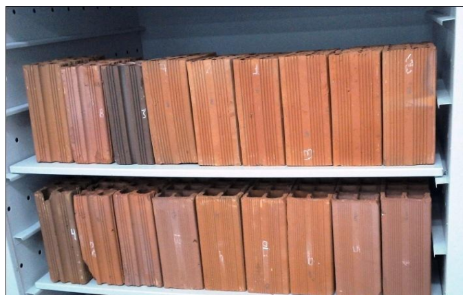
Figura 17 – Blocos cerâmicos na estufa. Fonte: Autor
