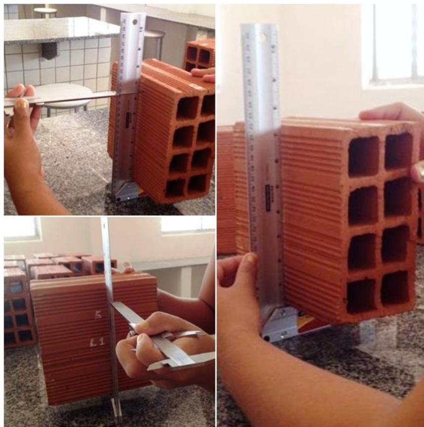
Figura 15 – Desvio em relação ao esquadro. Representação sistemática
