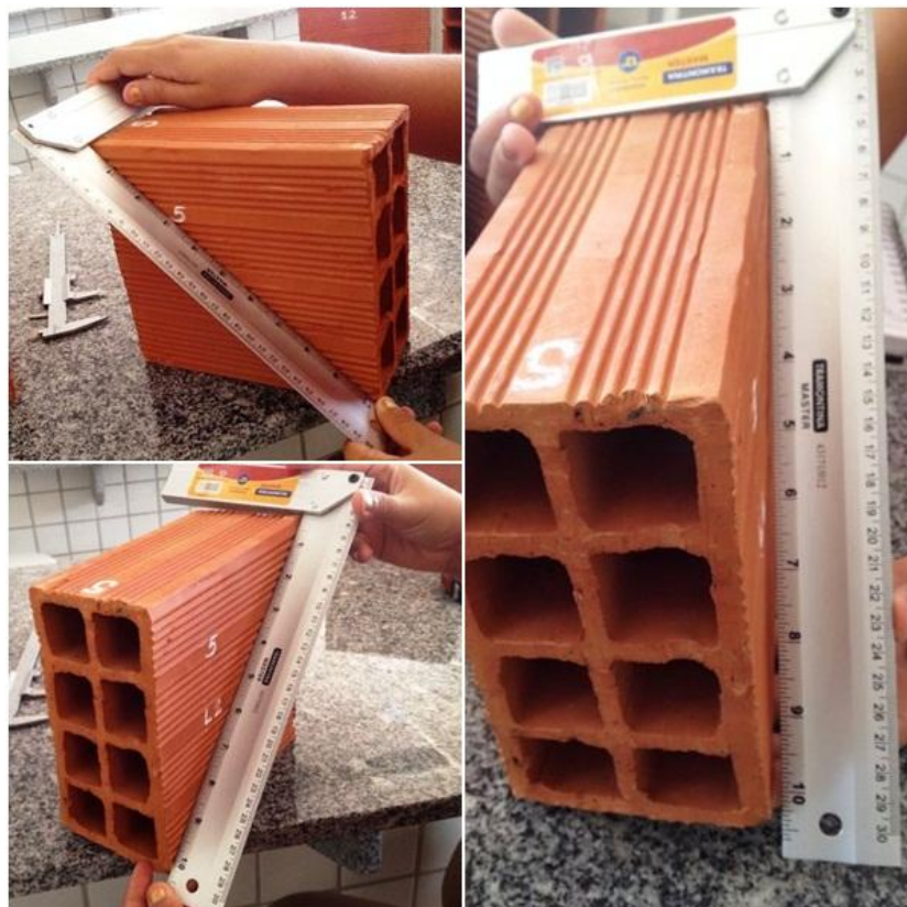
Figura 16 – Planeza das faces. Representação esquemática.
