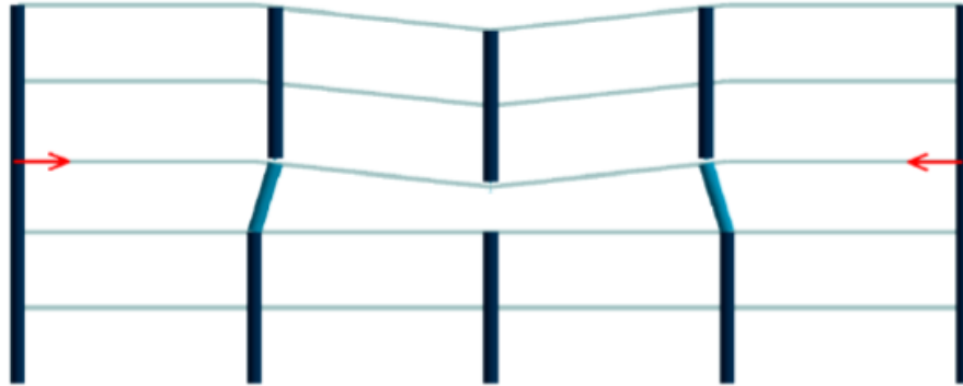
Figura 14 - Exemplo de colapso tipo dominó: desmoronamento dos pilares.
