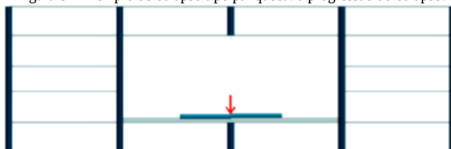
Figura 8 - Exemplo de colapso tipo panqueca: a progressão do colapso.
