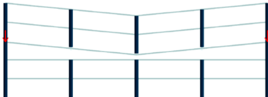
Figura 12 - Exemplo colapso do tipo zíper: excesso de carga nos pilares, resultando no colapso progressivo.
