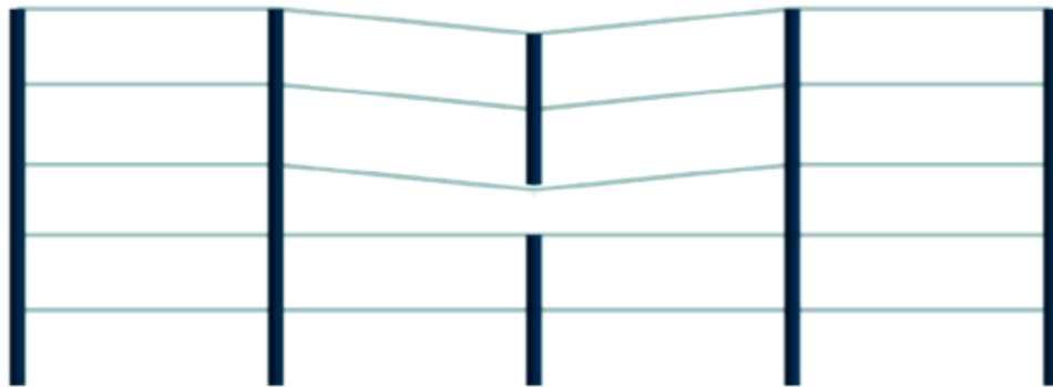
Figura 10 – Exemplo colapso do tipo zíper: perda de resistência do pilar.
