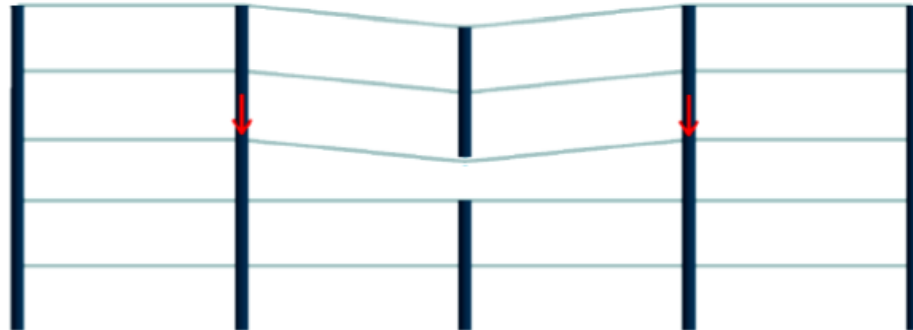
Figura 11 - Exemplo colapso do tipo zíper: aumento da carga nos elementos adjacentes.
