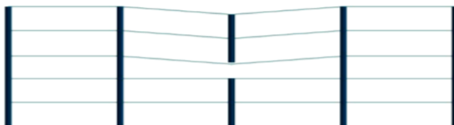
Figura 5 - Exemplo de colapso tipo panqueca: perda de resistência do pilar.
