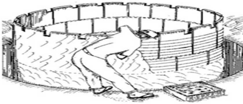
Figura 1: Armação da parede e reboco externo de cisterna de placas
