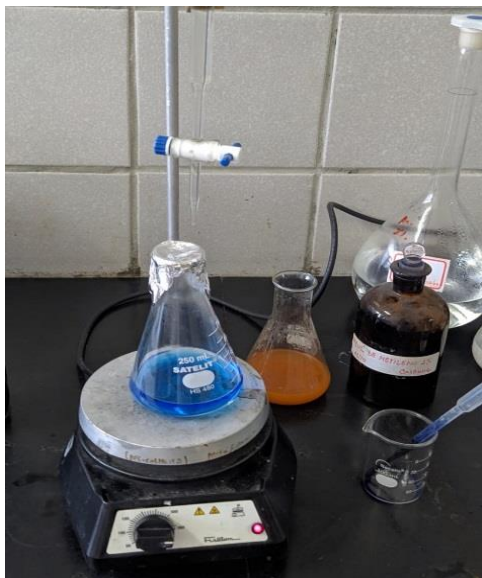
Figura 4. Titulação, método Lane-Eynon (Autoria própria) Figura 5. Ponto final de titulação (Autoria própria)
