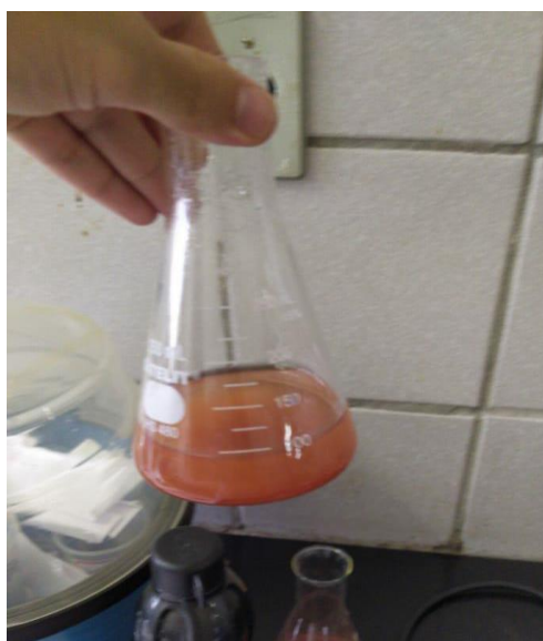
Figura 4. Titulação, método Lane-Eynon (Autoria própria) Figura 5. Ponto final de titulação (Autoria própria)
