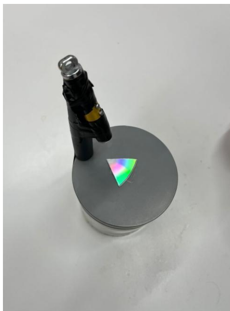
Figura 3 – Experimento visualização de ondas sonoras com laser e membrana
