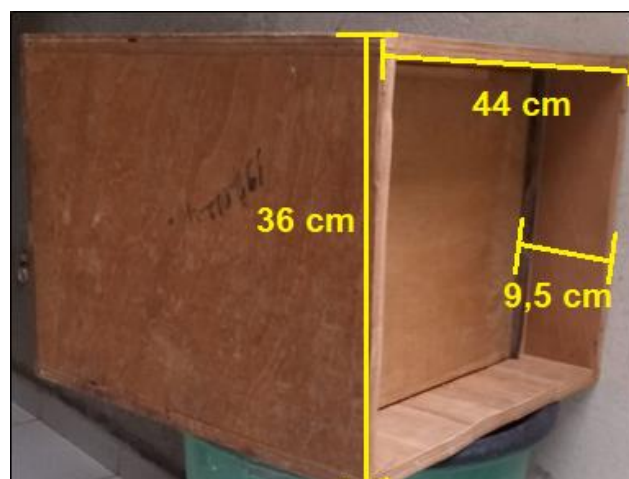
Figura 30: Vista do compartimento de acomodação dos circuitos.
