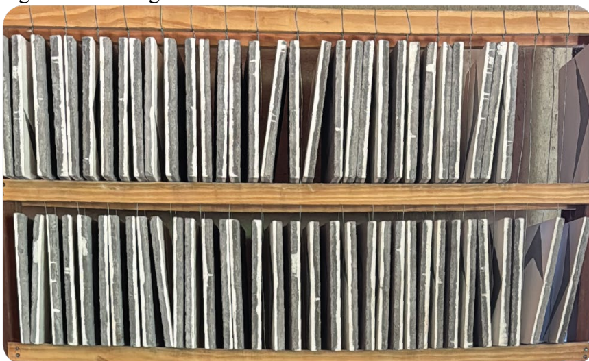
Figura 12 – Secagem de cura em estantes de madeira
