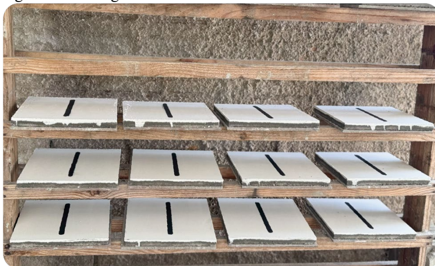
Figura 10 – Secagem do ladrilho em estante de madeira
