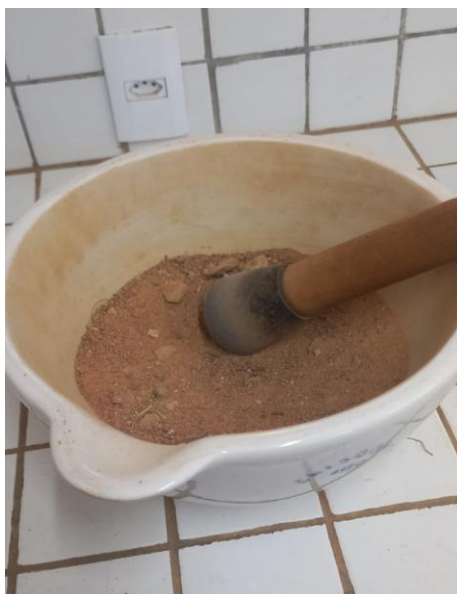
Figura 5 – Destorroamento do solo.
