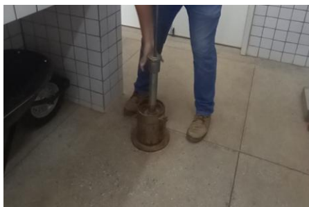
Figura 13 – Compactação do solo
