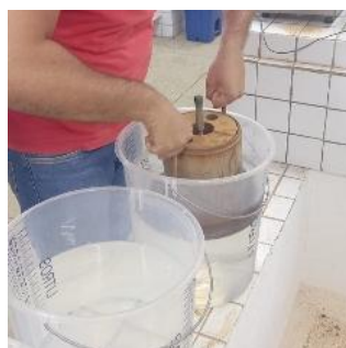
Figura 18 – Retirada de corpo de prova da submersão.
