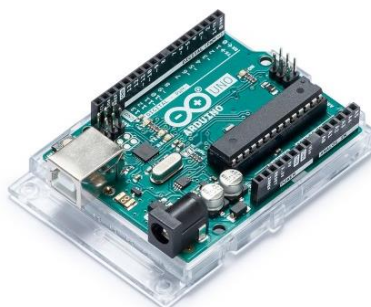
Figura 3. Arduino Uno. (Fonte: Ref. [4])
