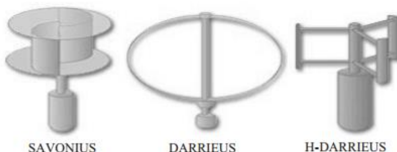
Figura 2.5.1 – Principais tipos de turbinas de eixo vertical.
