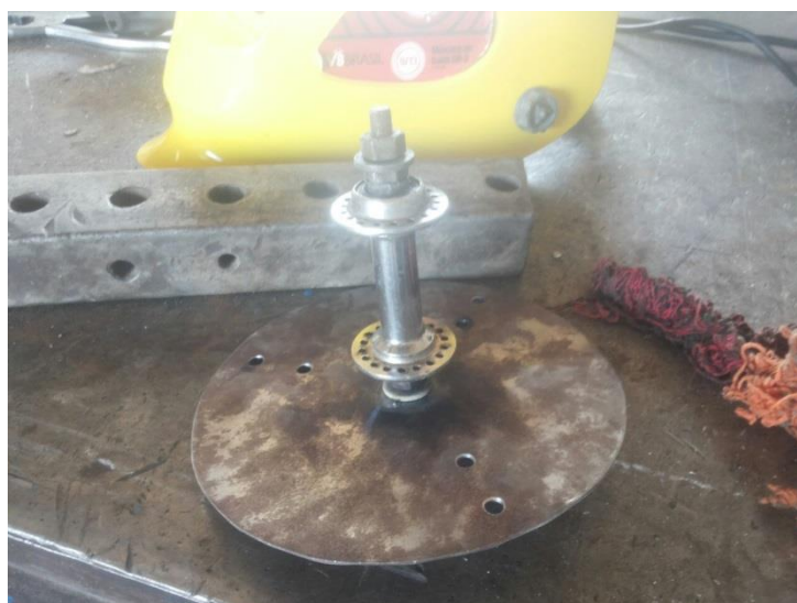
Figura 5.2.1 – Suporte das pás finalizado.
