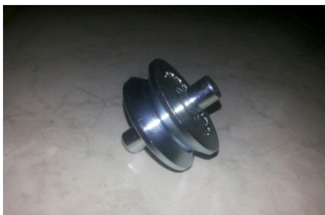
Figura 5.1.11 – Polia de 5 cm de diâmetro utilizada no sistema mecânico de transmissão de potência.
