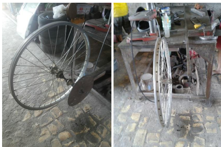
Figura 5.2.2 – Cubos soldados, criando um eixo.
