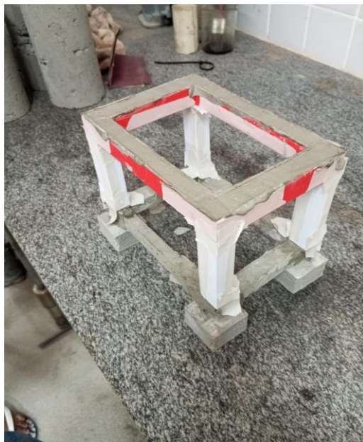
Figura 11 – Montagem e preenchimento dos pilares.
