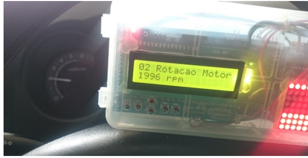
Figura 39 – Protótipo de UCE, medição da rotação do motor.
