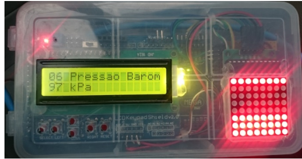
Figura 43 – Protótipo de UCE, medição da pressão barométrica.
