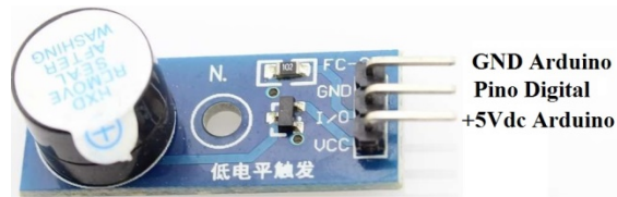
Figura 34 – Módulo buzzer e descrição da conexão dos pinos.
