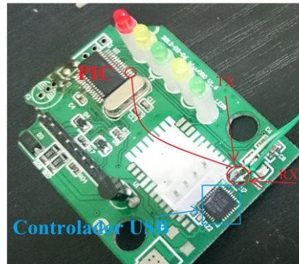
Figura 29 – Conexão para comunicação serial UART.
