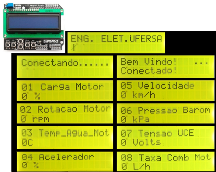
Figura 33 – Display lcd, rotina de inicialização e menu do protótipo.
