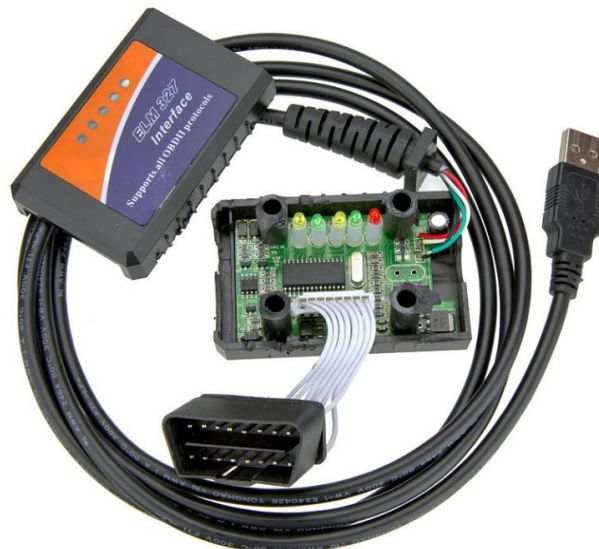
Figura 21 – Controlador CAN ELM327, versão comunicação USB.
