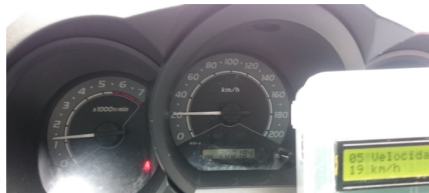
Figura 42 – Protótipo de UCE, medição da velocidade do veículo.
