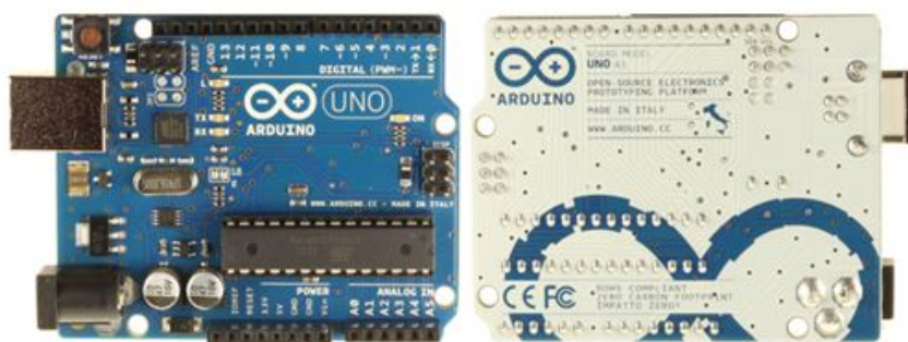
Figura 05 – Arduino Uno R3 (vista superior e inferior).
