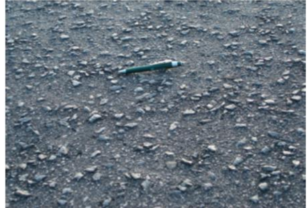
Figura 27 – Ex. 2 agregados polidos.
