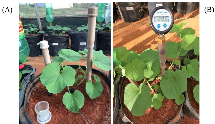
Figura 10: (A) Instalação dos tensiômetros e extratores da solução do solo; (B) Monitoramento da umidade do solo e através do tensiômetros instalados.
