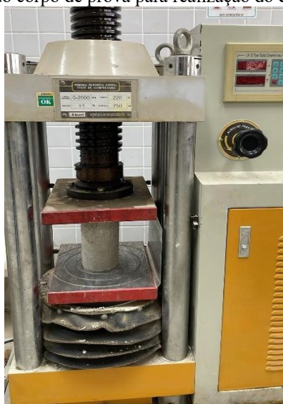
Figura 16: Organização do corpo de prova para realização do ensaio de compressão axial.
