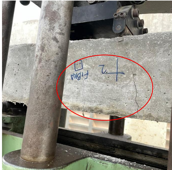
Figura 19: Aparecimento de fissuras de flexão ocorrida nas vigas armadas com GFRP.
