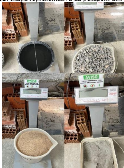
Figura 12: Etapa representativa da pesagem dos materiais.
