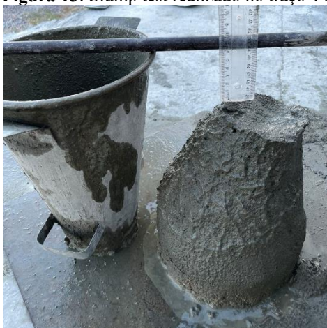
Figura 13: Slump test realizado no traço T1.
