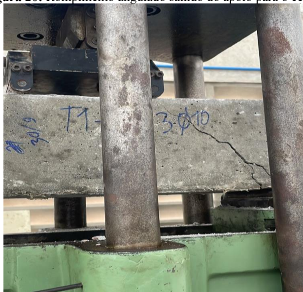
Figura 20: Rompimento angulado saindo do apoio para o centro.
