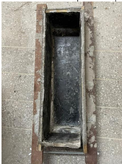
Figura 7: Modelo de forma utilizado para confecção dos prismas.
