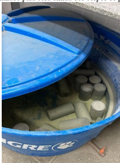
Figura 15: Local utilizado para cura úmida dos corpos de prova durante 28 dias.
