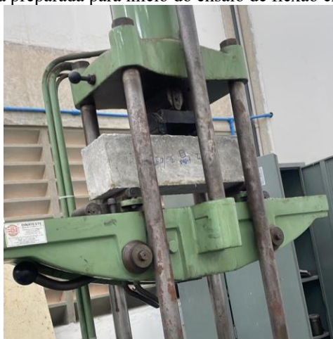
Figura 17: Viga preparada para início do ensaio de flexão em quatro pontos.
