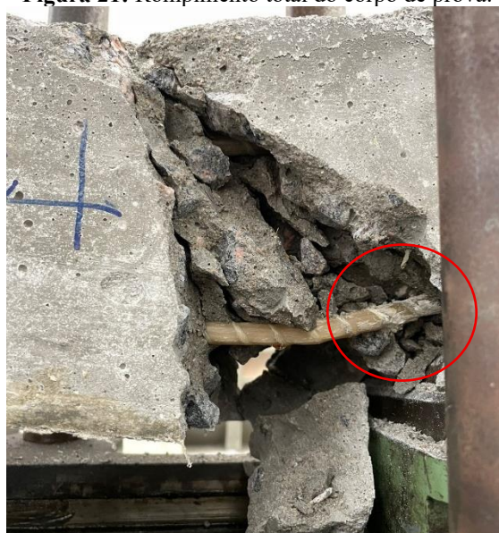
Figura 21: Rompimento total do corpo de prova.
