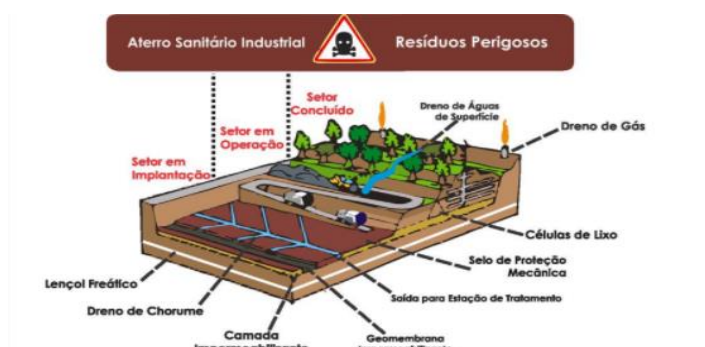
Figura 55: Perfil (Aterro para resíduos industriais Classe I)
