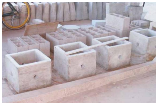
Figura 44: Confecção de caixas de gordura com agregados
