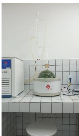
Figura 2: Processo da hidrodestilação das folhas do alecrim-pimenta (Autoria Própria)
