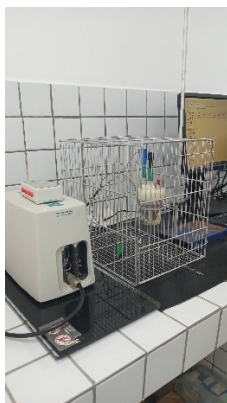
Figura 7: Gaiola de Faraday onde realiza-se os testes de impedância e polarização (Autoria Própria)
