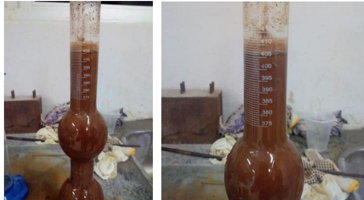
Figura 21 – Realização do ensaio de frasco de Chapman.
