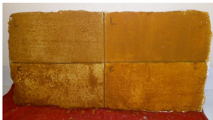
Figura 33 – Terceira demão das geotintas C e L, respectivamente.
