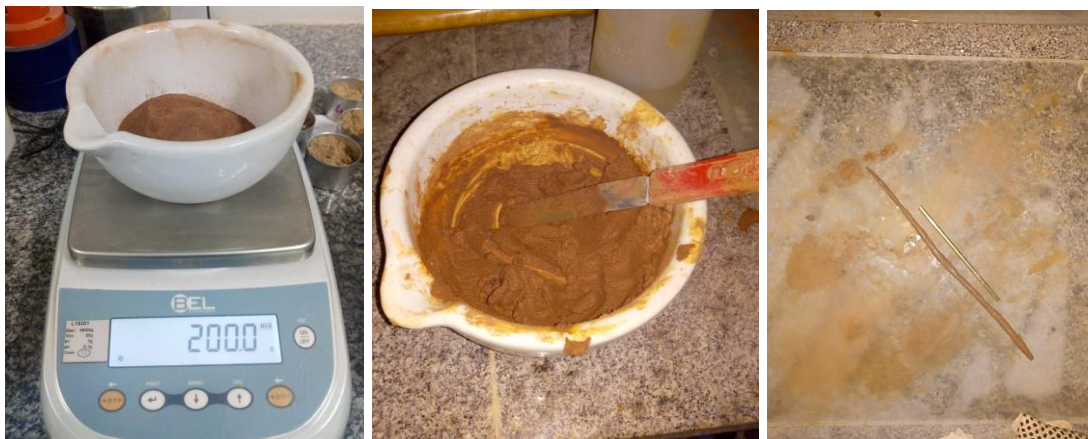
Figura 19 – Realização do ensaio de limite de plasticidade.
