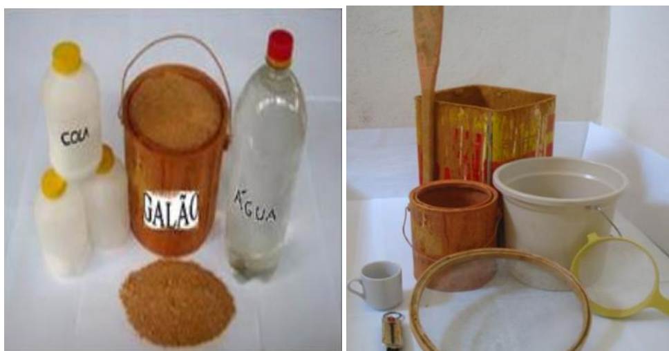
Figura 7 – Elementos necessários para fabricação da geotinta.
