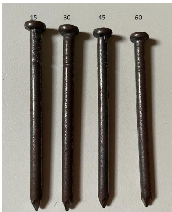
Figura 13: Corrosão pelo oxigênio
