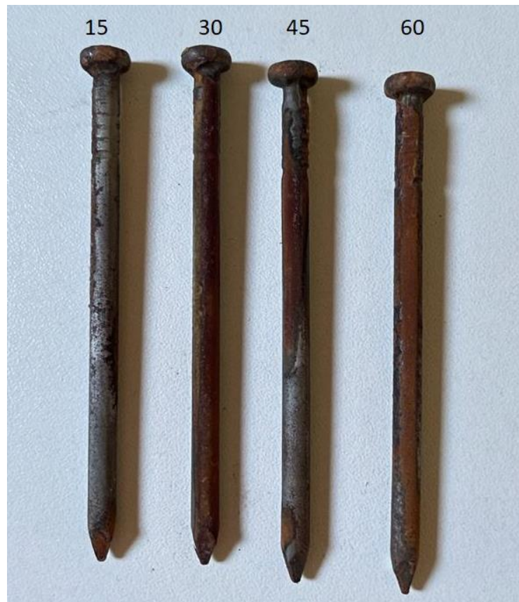
Figura 11: Corrosão por água salgada.
