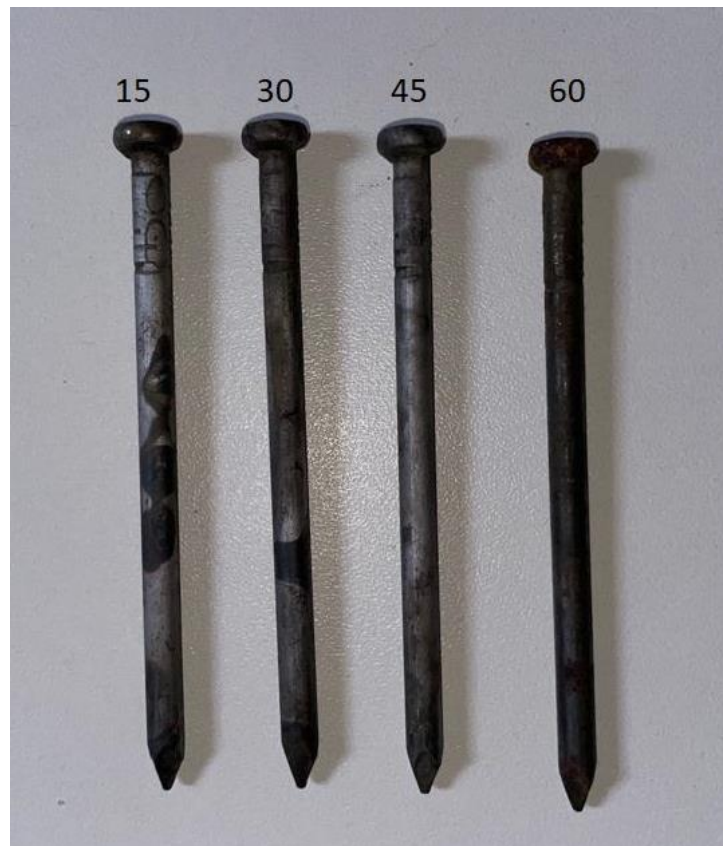
Figura 12: Corrosão pela água da chuva.
