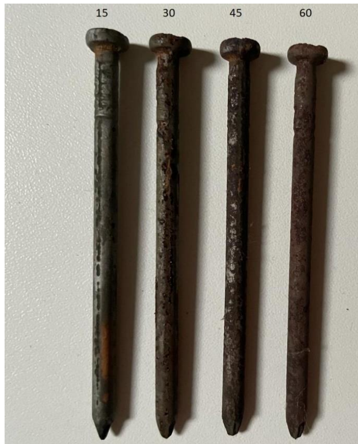
Figura 10: Corrosão por meio ácido
