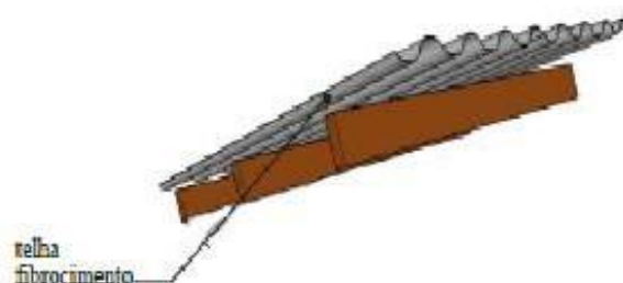
Figura 12: Telha de fibrocimento
