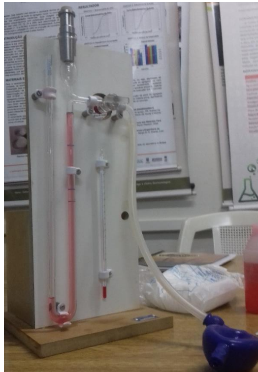
Figura 5: Determinação da superfície específica pelo método de Blaine
