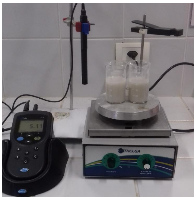
Figura 10: Determinação do índice de atividade pozolânica pelo método da condutividade elétrica
