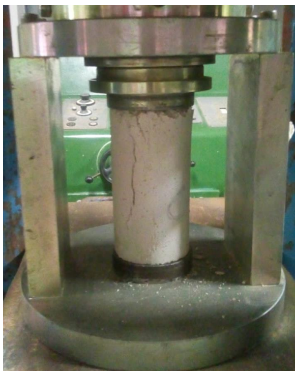
Figura 8: Determinação do índice de atividade pozolânica com cimento Portland
