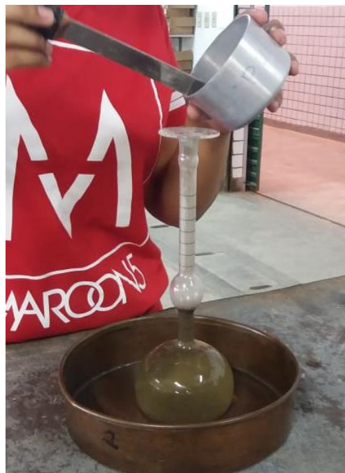
Figura 4: Determinação da massa específica real do cimento utilizando o frasco de “Le Chatelier”
