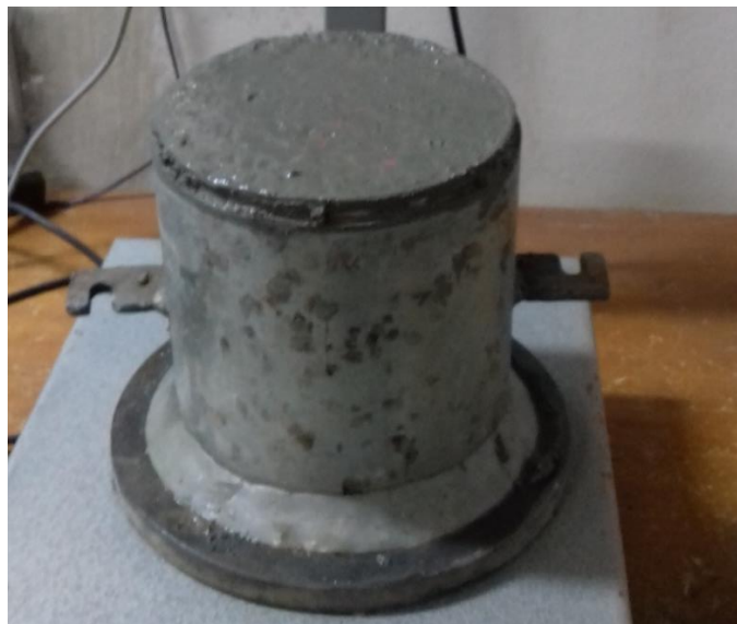
Figura 15: Determinação da massa específica no estado fresco
