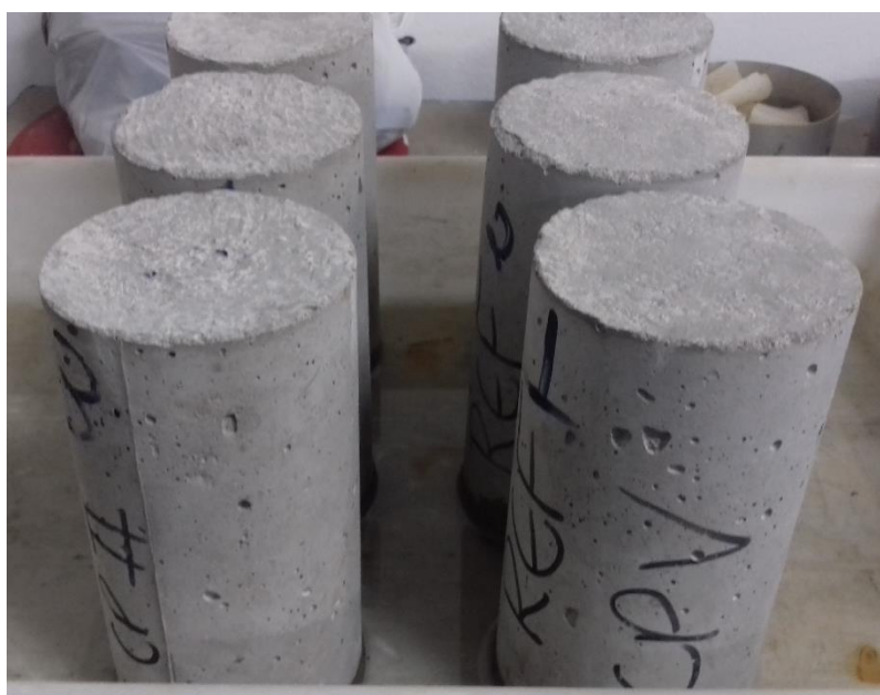
Figura 18: Corpos de prova em ensaio de absorção por capilaridade
