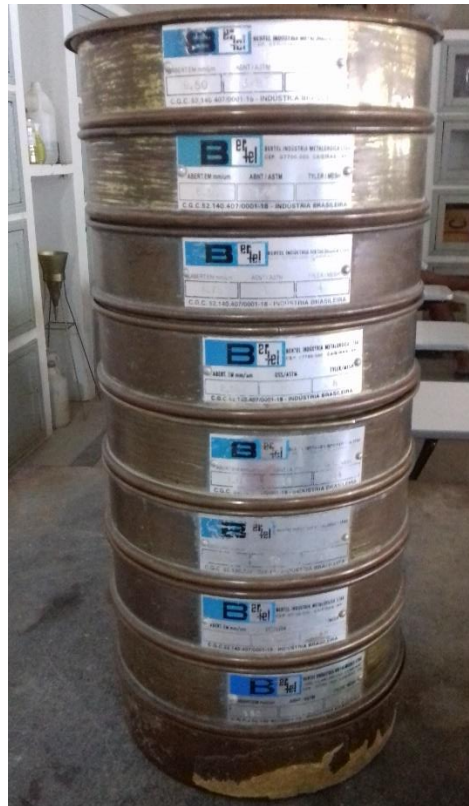
Figura 6: Determinação da composição granulométrica por peneiramento
