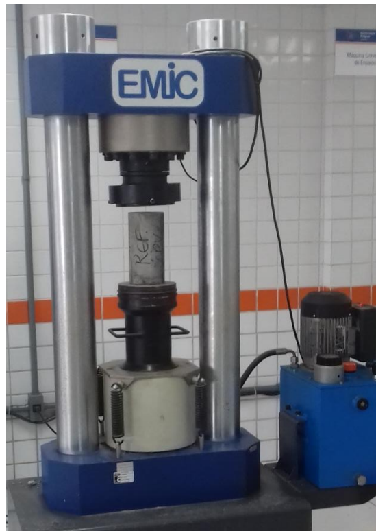
Figura 16: Ensaio de resistência à compressão axial
