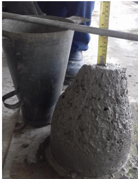
Figura 14: Determinação da consistência pelo slump test
