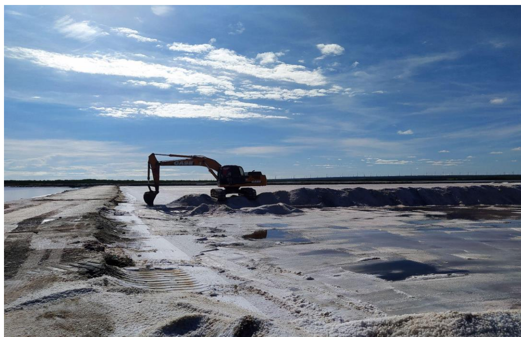
Figura 16 - Cristalizador durante a etapa de colheita do sal
