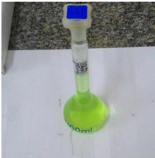
Figura 24- Análise do teor de ferrocianeto de sódio na amostra de sal
