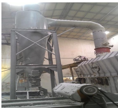
Figura 16- Secador leito fluidizado (A) e ciclone (B)
