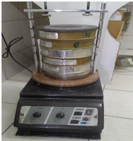
Figura 25- Peneira Vibratória utilizada na análise granulométrica
