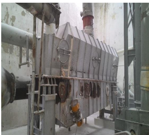
Figura 16- Secador leito fluidizado (A) e ciclone (B)
