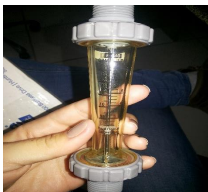
Figura 28- Rotâmetro medidor de vazão
