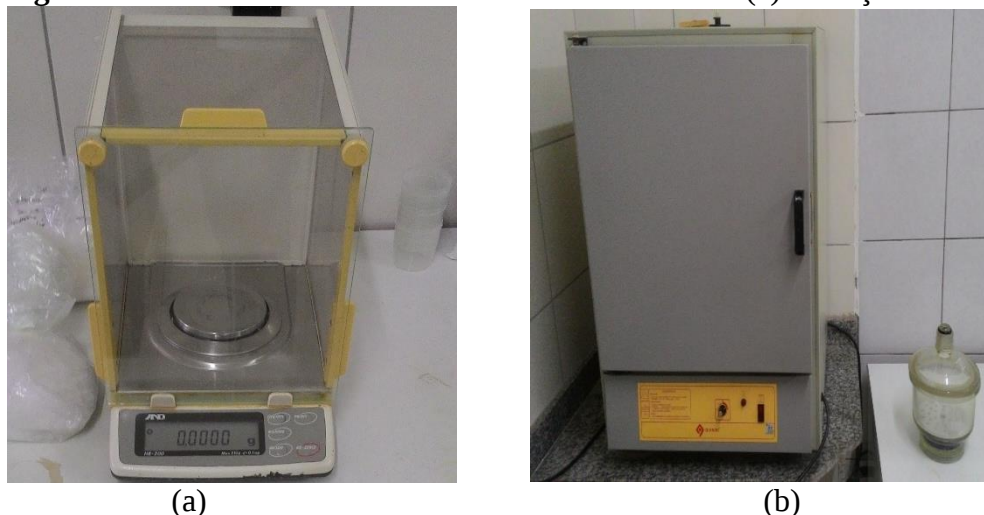
Figura 27- Análise do teor de umidade na amostra de sal (a) balança analítica (b)
