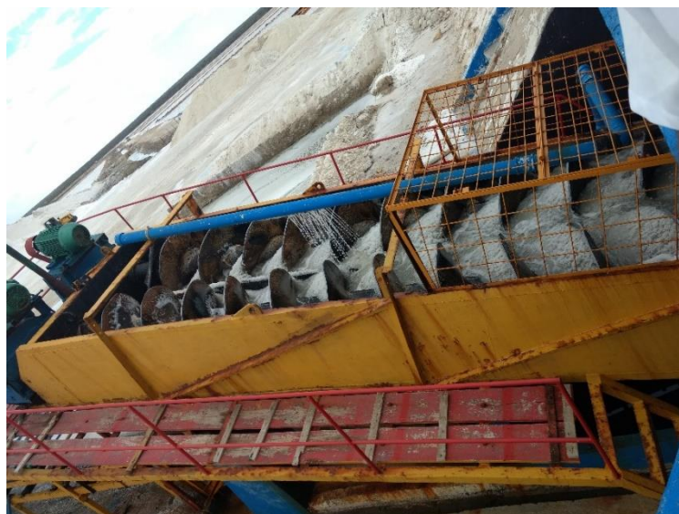
Figura 5 – Lavagem do sal em roscas helicoidais.
