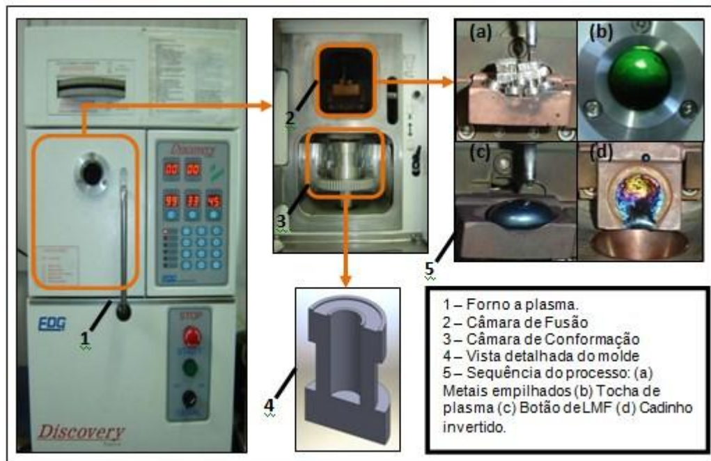
Figura 18 – Fluxograma do processo de fabricação empregado para obtenção dos atuadores de LMF.
