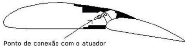
Figura 8 – Modelo básico de uma asa de avião com flap.
