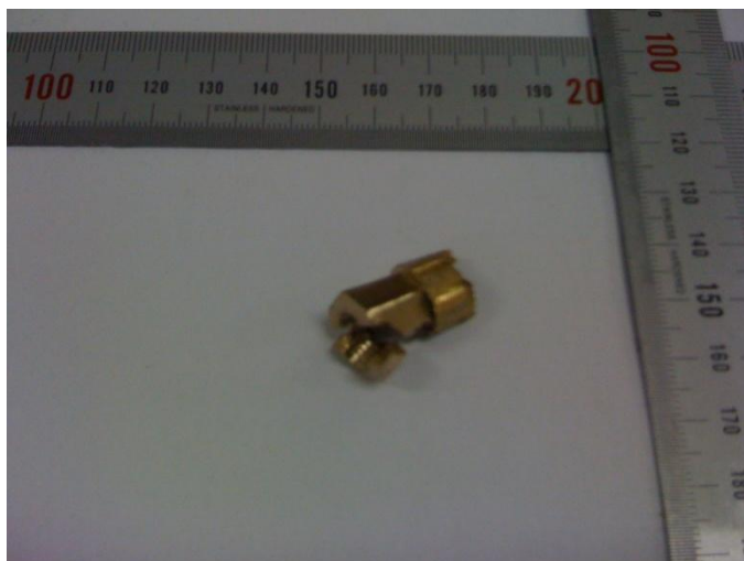
Figura 20 – Atuador de LMF tipo porca Castelo após falha durante o processo de Usinagem.
