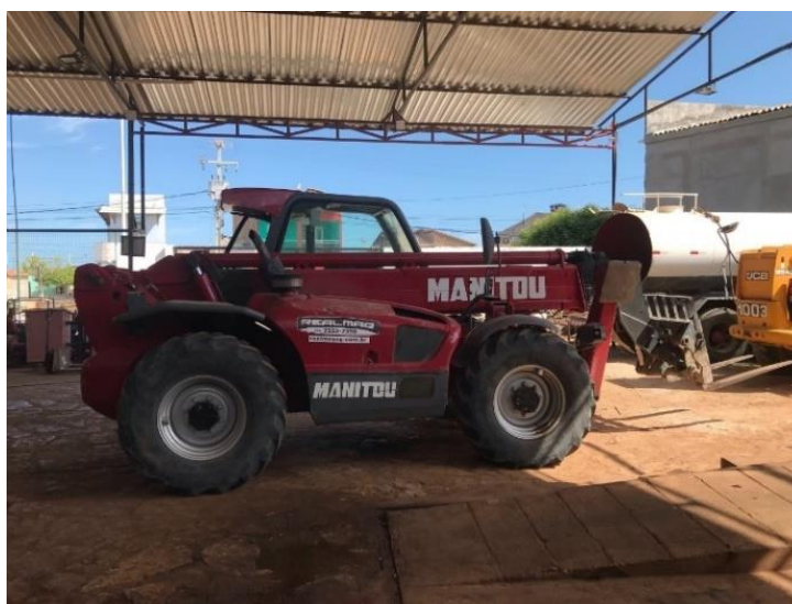
Figura 8 - Manipulador Telescópio Manitou MTX 1740 S3E3.
