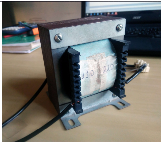
Figura 3. Transformador montado. (Autoria própria)
