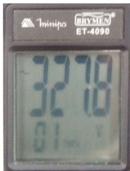
Figura 11. Medição de tensão realizada para 220/330 V. (Autoria própria)
