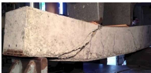
Figura 4: Viga de concreto armado, submetida ao ensaio de flexão. Fonte: [11]
