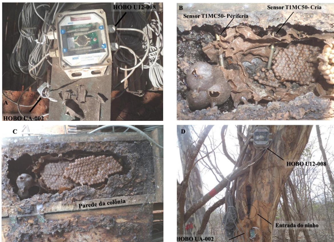
Figura 1. A- Posição dos carregadores de dados no ninho na caixa racional; B- Posicionamento dos sensores dentro do ninho, na região dos discos de cria e na periferia da cria; C- Parede da caixa racional; D- Posição dos carregadores de dados no ninho na árvore ( Chloroleucon dumosum ) e a entrada da colônia (circulo amarelo).
