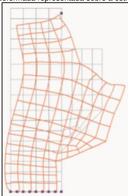
Figura 3 - Malha deformada representada sobre a estrutura indeformada.
