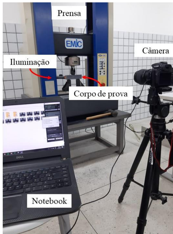
Figura 14: Estrutura para a execução da CDI.
