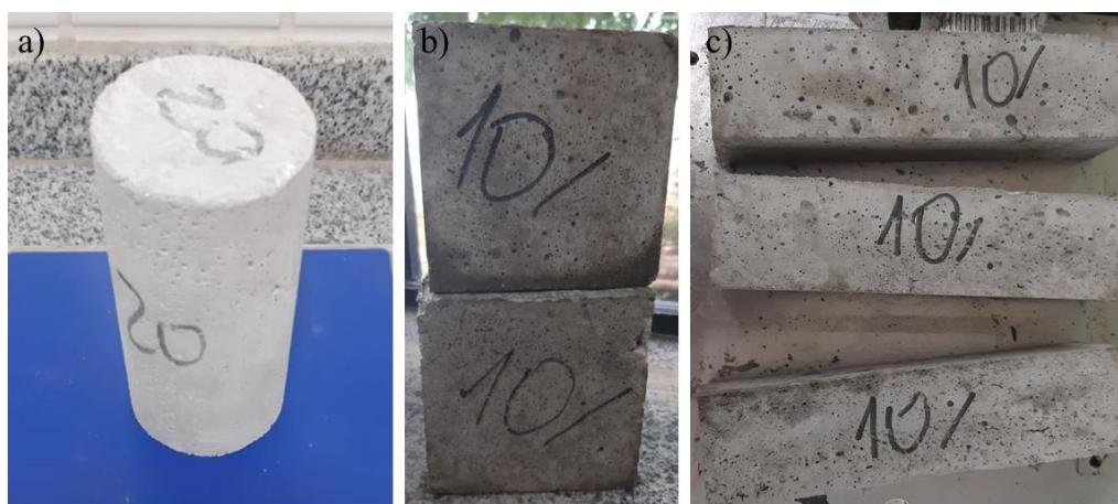
Figura 12: Formato dos corpos de prova; a) cilíndrico, b) cúbico, c) prismático.
