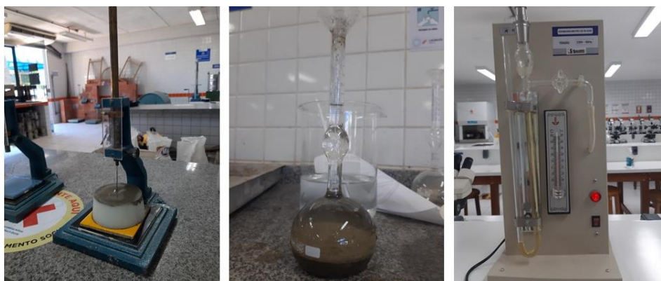
Figura 3: Ensaios de determinação das propriedades do cimento – Determinação do tempo de pega, Determinação da massa específica real e Determinação da finura pelo método de Blaine, respectivamente.
