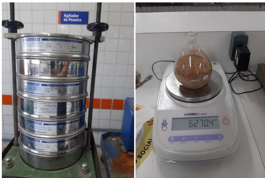
Figura 4: Ensaio de granulometria e massa específica da areia.
