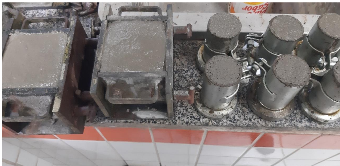
Figura 11: Corpos de prova moldados após confecção das argamassas.
