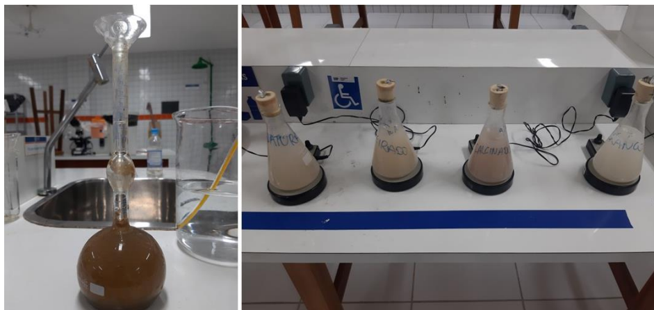
Figura 8: Determinação da massa específica e do índice de atividade pozolânica do RSF.
