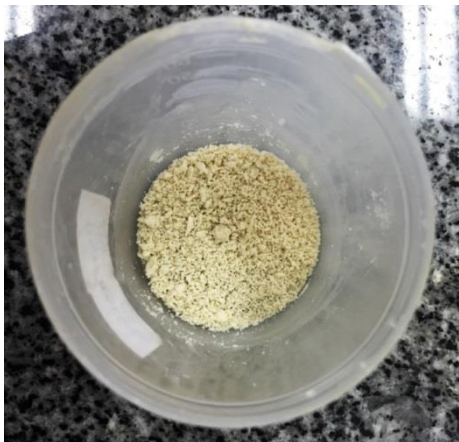
Figura 7 - Obtenção dos sais sólidos da água do Rio Apodi/Mossoró.
