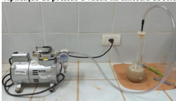
Figura 9 - Aplicação de pressão a vácuo na amostra de solo mais água
