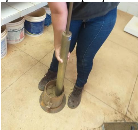
Figura 11 - Execução do ensaio de compactação a energia intermediária
