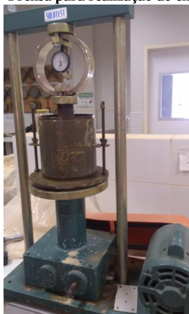
Figura 11 - Prensa para realização do ensaio de ISC
