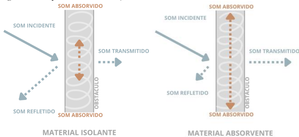
Figura 4 - Esquema de distribuição sonora em materiais isolantes e absorventes.
