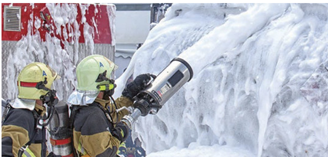
Figura 13 – Utilização de Espuma Aquosa ou Mecânica
