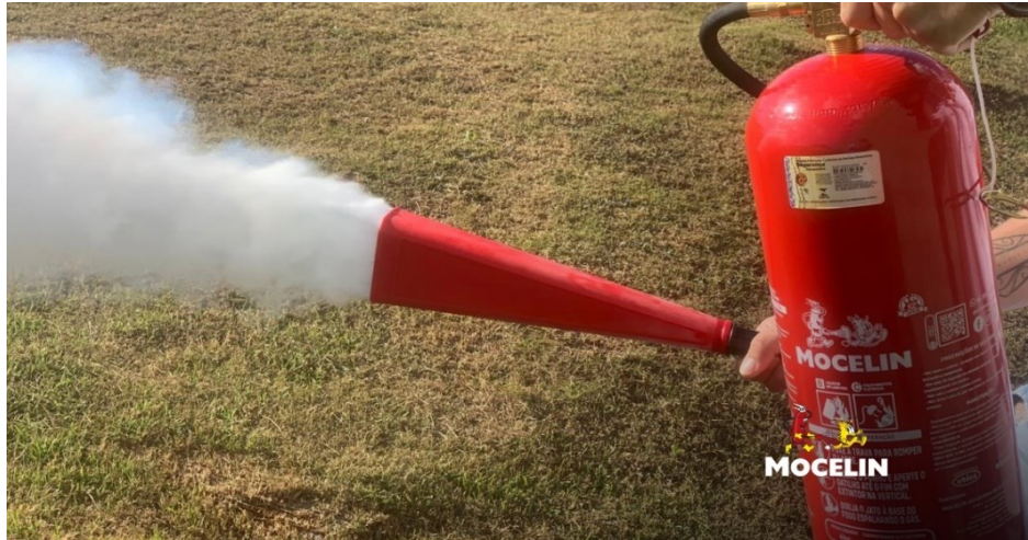
Figura 14 – Utilização de Gás Inerte ( \text{CO}_2 )
