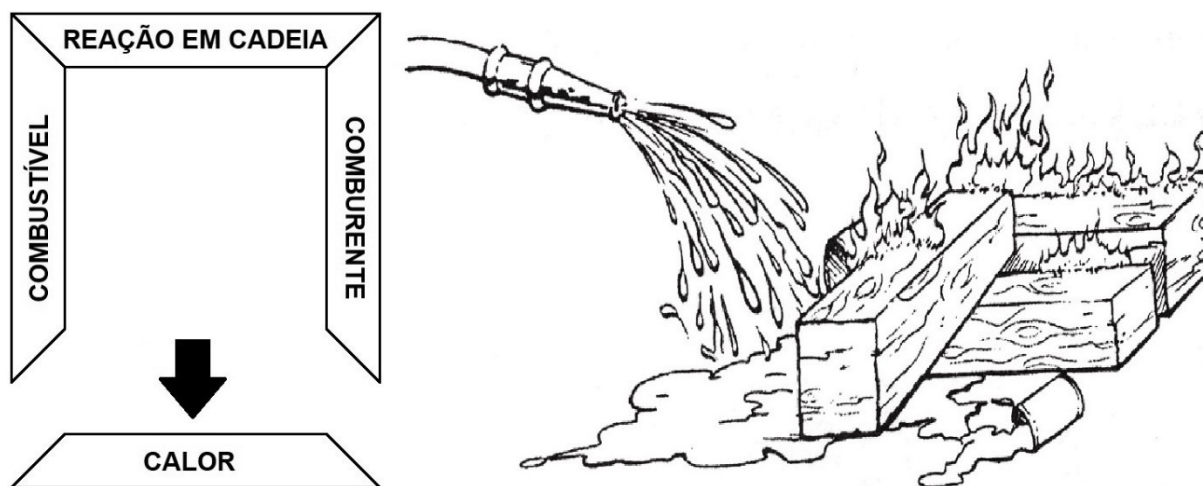
Figura 9 – Extinção do fogo por retirada do calor
