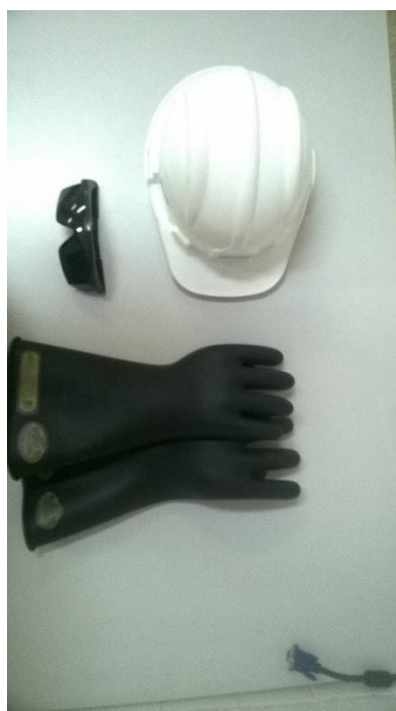
Figura 7 - EPI's utilizado nas medições de fator de potência na UFERSA – Campus Pau dos Ferros.
