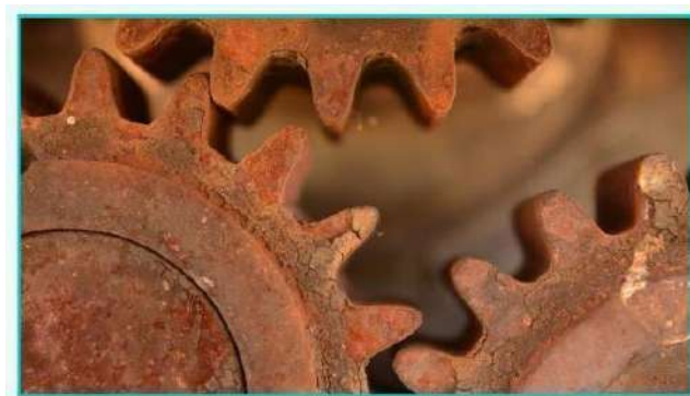
Figura 1: Engrenagens metálicas em processo de corrosão uniforme.
