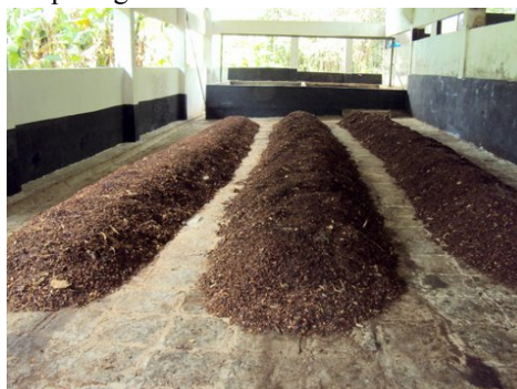
Figura 2 - Compostagem no método de leiras revolvidas ( windrow )
