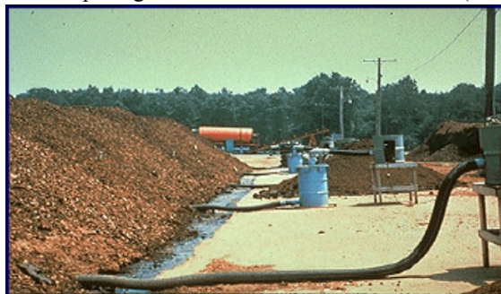
Figura 3 - Compostagem no método de leiras estáticas ( static piles )
