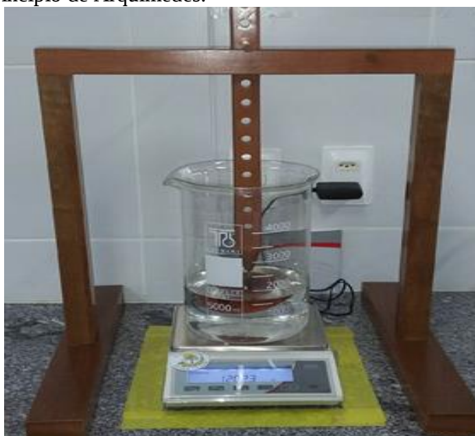
Figura 7 – Determinação do volume para o cálculo de densidade básica por meio do princípio de Arquimedes.
