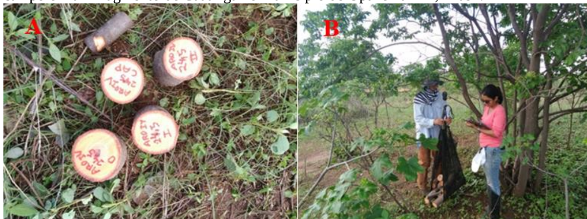
Figura 5 – Amostras em forma de disco (A) e pesagem das amostras (B) componente fuste no campo em um fragmento de Caatinga no município de Upanema-RN, Brasil.
