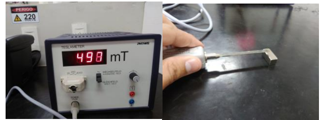
Fig. 2. Medição do campo remanescente com o gaussímetro.
