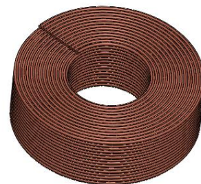
Fig. 6. Modelagem da bobina geradora.
