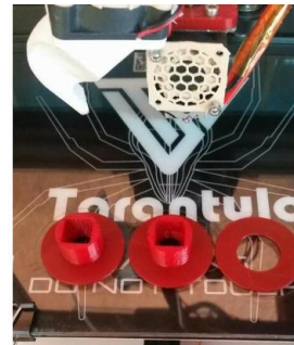
Fig. 15. Impressão dos carretéis das bobinas do gerador.
