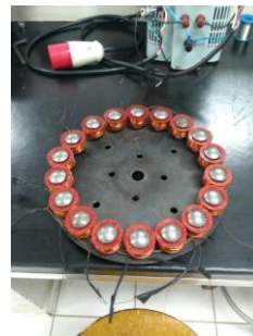
Fig. 19. Fixação das bobinas geradoras.
