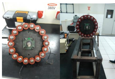
Fig. 21. Fixação do estator na base do conjunto gerador-motor cc.
