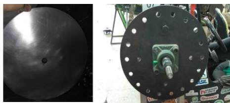
Fig. 14. Placas do estator e rotor do gerador
