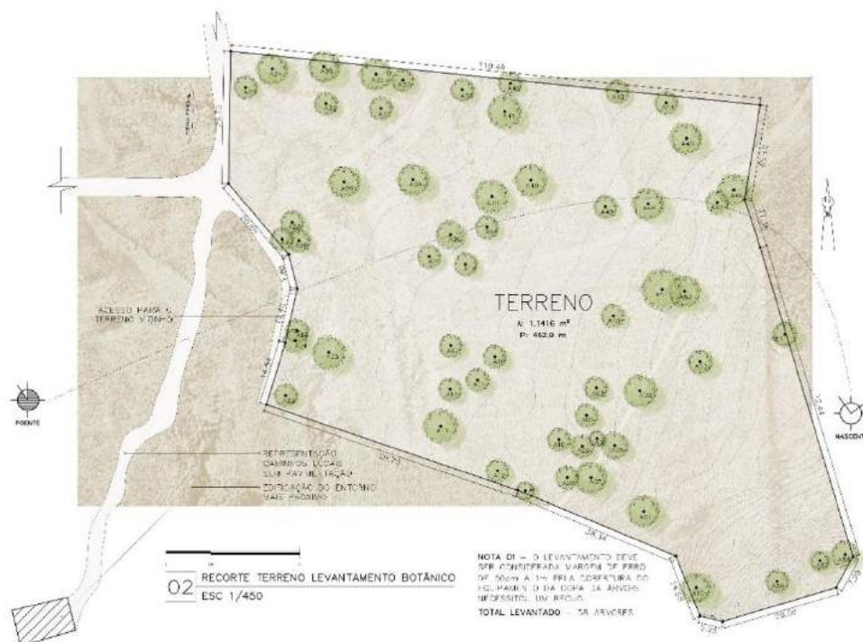
Figura 69 – Levantamento das árvores existentes.
