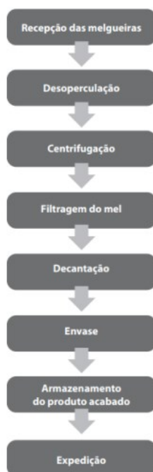
Figura 4 - Processamento da Casa de mel
