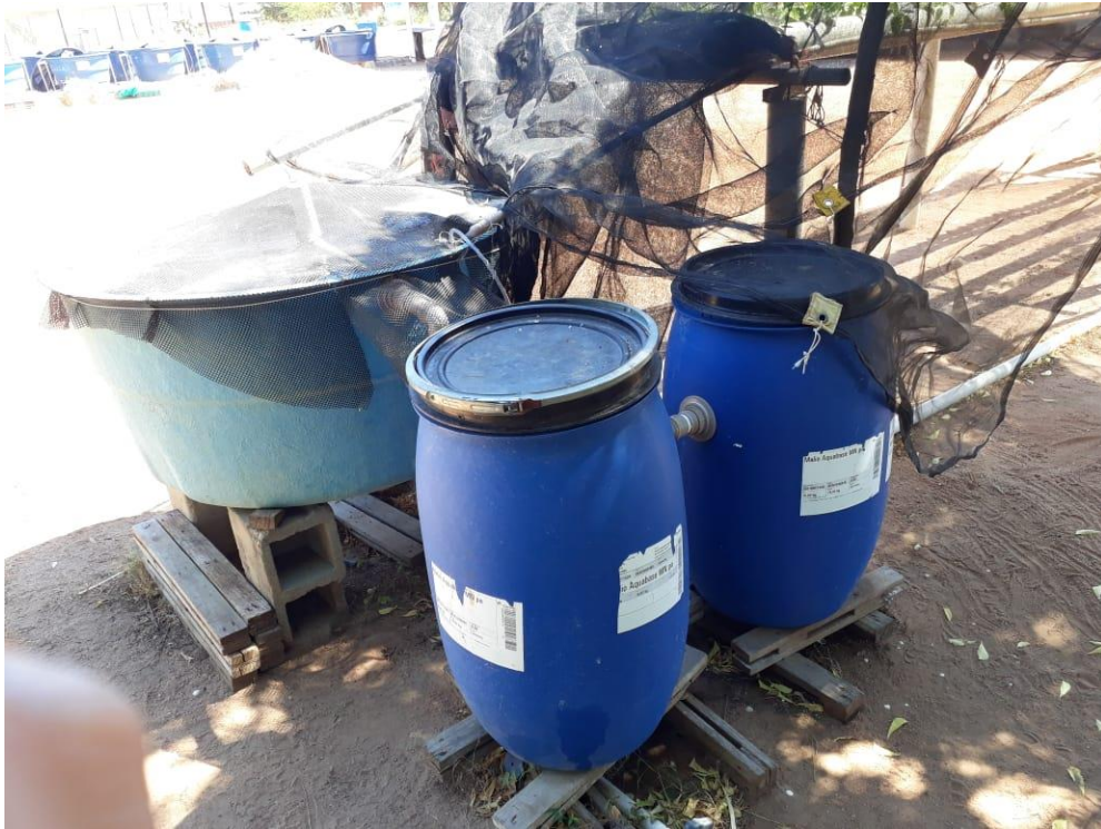
Figura 4: Bobonas utilizadas como filtros mecânico e biológico.
