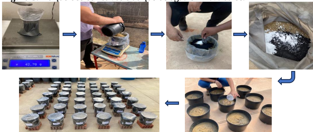
Figura 3. Adição dos corretivos e adição de água em 70% da cc.
