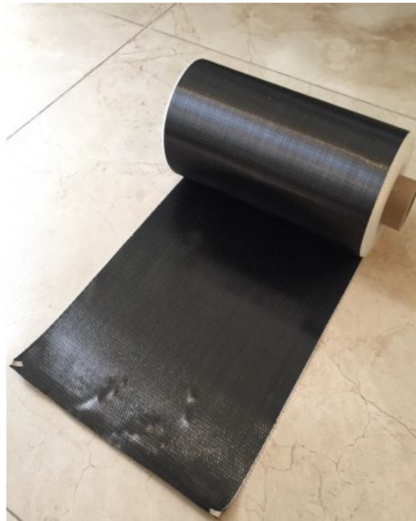
Figura 6: Manta feita de compósito de fibra de carbono em sua forma comercial
