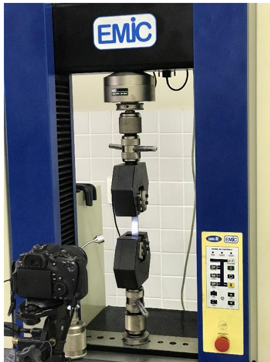
Figura 26 - Ensaio de tração em compósito utilizando correlação digital de imagens
