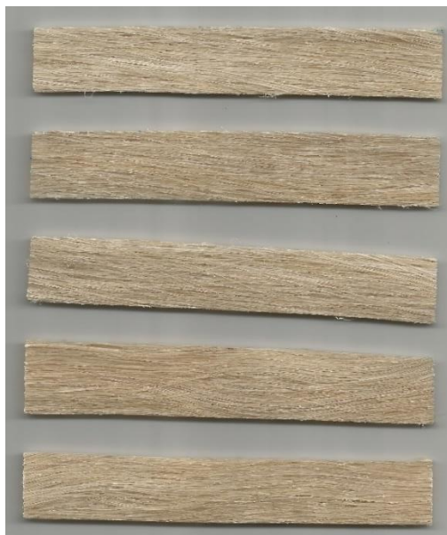
Figura 24 - Corpos de prova de tração de compósitos unidirecionais sem tratamento químico
