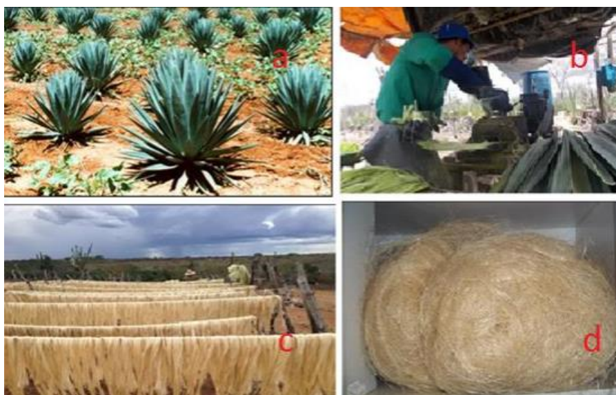
Figura 14 - Etapas do processamento das fibras de sisal: (a) plantação de sisal; (b) desfibramento; (c) secagem ao ar livre; (d) fibra de sisal.
