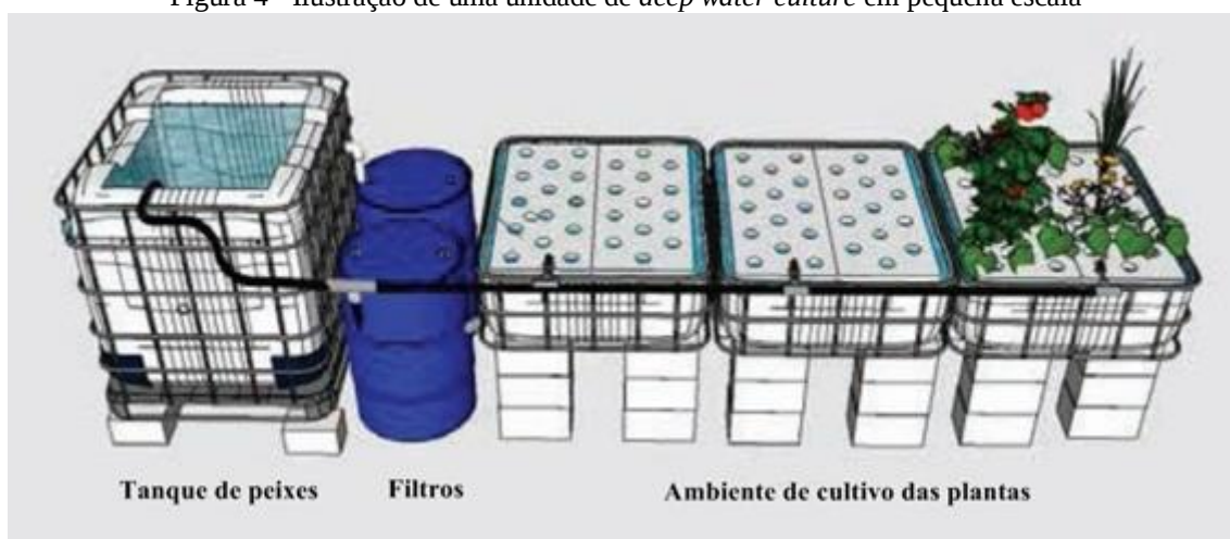
Figura 4 - Ilustração de uma unidade de deep water culture em pequena escala
