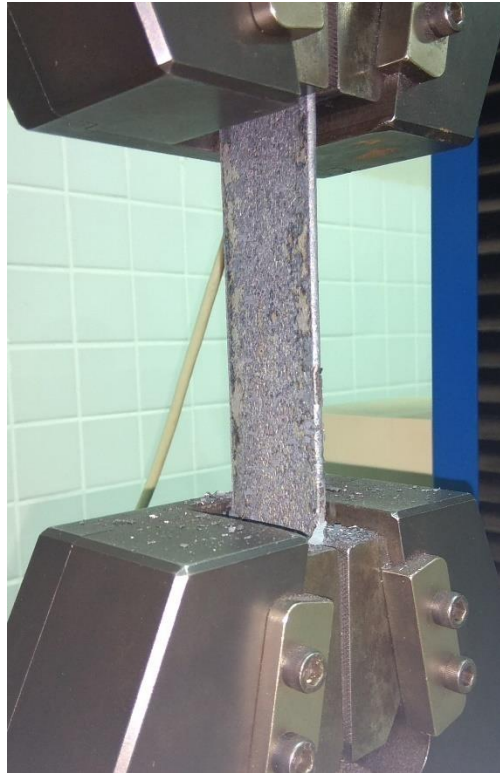
Figura 13 - Corpo de Prova sem furo na máquina de tração
