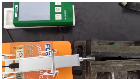
Figura 5- Configuração usada para o ensaio de rugosidade
